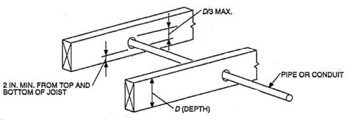
**BORED HOLES IN JOISTS**
